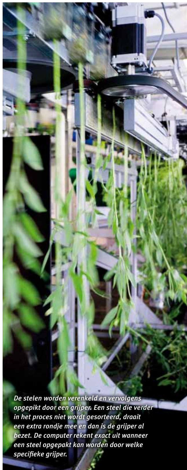
Om het voor het camerasysteem makkelijker te maken om te sorteren, wordt de afstand tussen de stelen verdubbeld. De rij stelen splitst zich in twee rijen.
