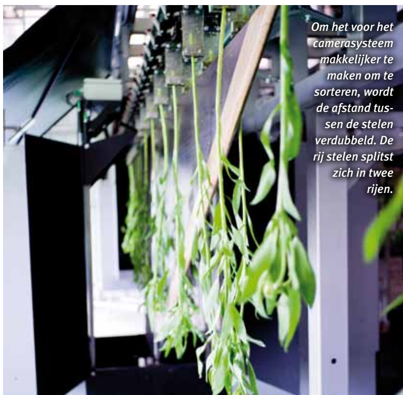
De stelen veranderen van oriëntatie: via de zwarte geleidesnaar worden ze vlot, doch zonder beschadigd te worden, in hangende positie gebracht.
