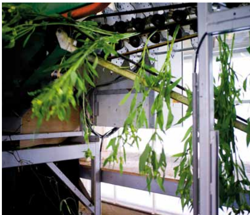
De stelen veranderen van oriëntatie: via de zwarte geleidesnaar worden ze vlot, doch zonder beschadigd te worden, in hangende positie gebracht.
