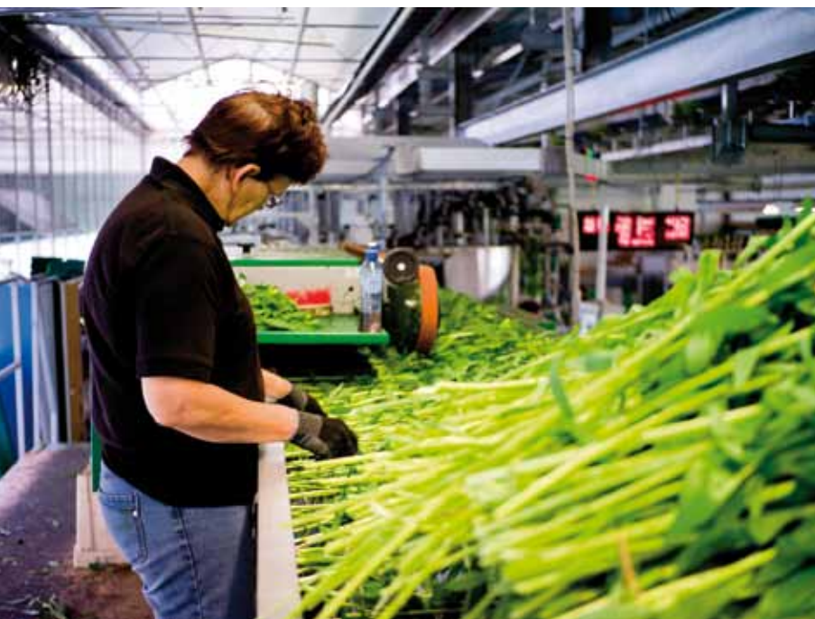
Voordat de stelen de machine daadwerkelijk ingaan, worden ze eenmaal visueel geïnspecteerd. Zeer kromme stelen worden er hier uitgehaald.
